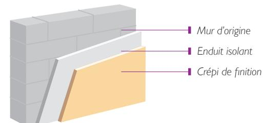
Le système se compose d'un **enduit isolant** minéral ou végétal **projeté** en une ou plusieurs couches ou **coffré** sur le mur à l'extérieur de l'habitation, et d'un **crépi de finition**. Les matériaux mis en œuvre doivent permettre l'évacuation de l'humidité par une régulation naturelle de l'hygrométrie, surtout dans le bâti ancien.
