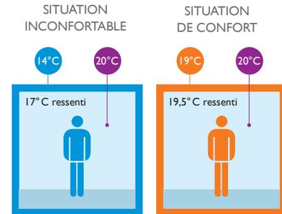
La sensation de « paroi froide » : un mur froid « aspire » la chaleur du corps. Ici, une paroi à 14°C et un air ambiant à 20°C entraînent une température ressentie de 17°C.
