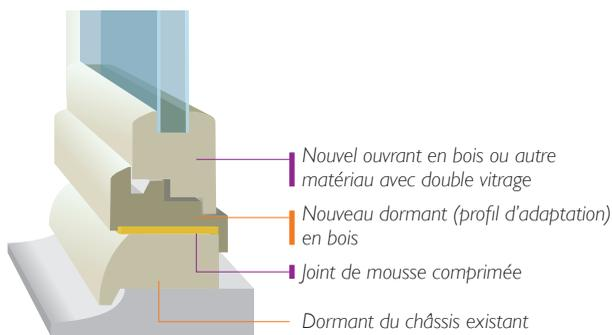
**Rapide et sans dommage** pour l'environnement immédiat de la baie (enduit, papier peint, baguette de finition, etc.), il nécessite toutefois un **bon état du dormant** de l'ancienne fenêtre. Il est réalisé en mettant en œuvre par recouvrement sur ce dormant une **nouvelle fenêtre complète** (dormant + ouvrant), en PVC, en aluminium ou en bois.
