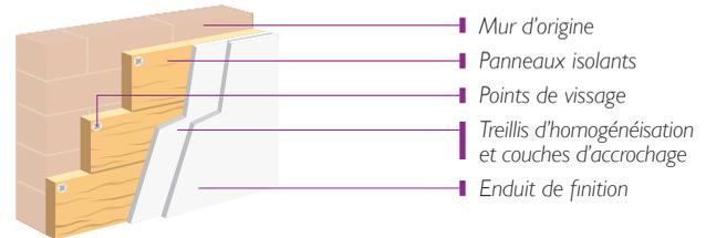
Les **panneaux isolants** sont **fixés** au mur **par collage** et/ou **vissage**. Ils sont recouverts d'un **treillis collé** puis d'un **enduit de finition**. C'est la solution la moins chère en isolation par l'extérieur.
