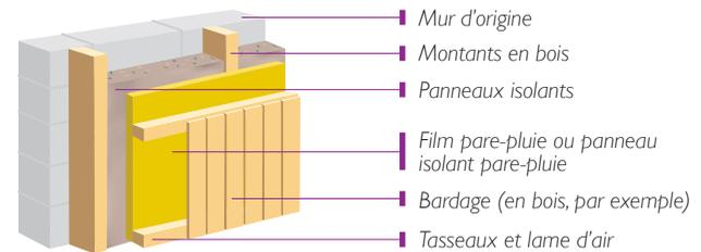
Des **panneaux isolants** sont **installés sur des montants** fixés au mur. Cet ensemble est protégé par un **film pare-pluie** ou un **panneau** respirant. Des **tasseaux horizontaux** permettent de poser un **bardage extérieur** tout en ménageant une **lame d'air** entre l'isolant et le bardage.
