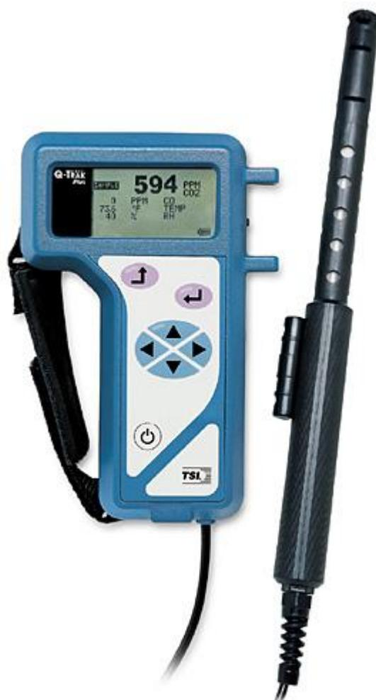
Le Q-TRAK Plus, modèle 8554 permet de mesurer simultanément le dioxyde de carbone, la température, l'humidité et le monoxyde de carbone avec une seule sonde. Facile à utiliser, c'est un instrument portatif qui fournit des mesures en temps réel et peut enregistrer des données sans surveillance pendant une période prolongée.
