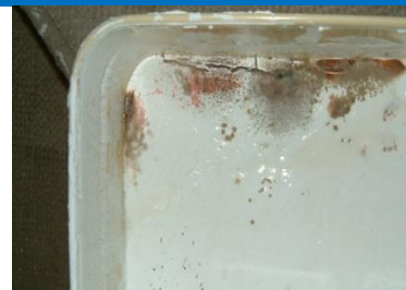
Moisissures dans un pot de peinture
