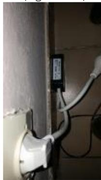
Figure 1-11 : Photographie d'un wattmètre communicant sur prise de courant.
