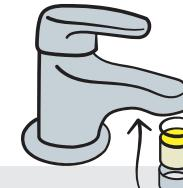
Les mousseurs sont des équipements fixés en sortie de robinet. Ils permettent de consommer moins d'eau en aérant le jet. Je demande conseil en magasin sur les modèles adaptés à mes installations.
