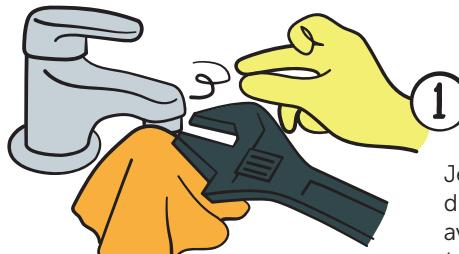
① Je dévisse la bague du robinet à la main ou avec une clé à mollette (et un chiffon si nécessaire).
